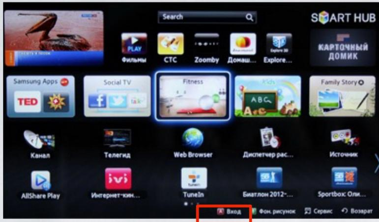
3. Задаём пользователя **develop**, задаём пароль **любые 6 цифр** и нажимаем **Вход**
